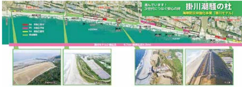
掛川市では、南海トラフ巨大地震による津波の浸水被害軽減を図るため、海岸防災林を、想定される津波(レベル2)に対応した高さにかさ上げをし、災害に強い海岸防災林として再生する掛川潮騒の杜 海岸防災林強化事業「掛川モデル」を行っています。
