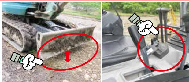
重機停止時にキーを差したままで排土板も浮いていた。運転席を離れるときはキーを外して排土板を下に下ろすよう指示した。(安衛則151条の11)
