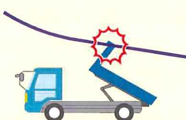
ダンプアップによる 架空線接触事故
