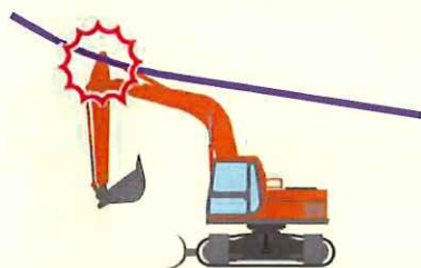
バックホウによる 架空線接触事故
