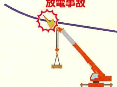
クレーンによる 放電事故
