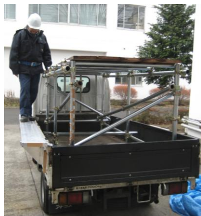
<あおりに取り付ける簡易作業床の例> (荷役安全設備マニュアル (パンフレット) より)
