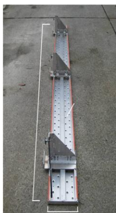
<あおりに取り付ける簡易作業床の例> (荷役安全設備マニュアル (パンフレット) より)
